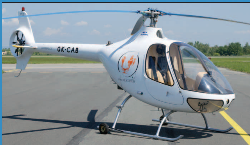
Pro přesun po zemi je vrtulník osazen kolečky, manipulaci s ním pak zvládne jedna osoba
